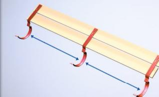
Крепление длинных кронштейнов производится на стропила или на обрешётку до монтажа кровельного покрытия. Кронштейны для установки желоба устанавливаются с шагом 500 – 800 мм.
