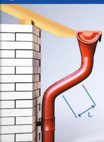
Замерьте расстояние между концами верхних отводов L. Отрежьте кусок соединительной трубы на 12 см длиннее, чем расстояние между отводами.
