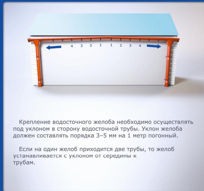
Крепление водосточного желоба необходимо осуществлять под уклоном в сторону водосточной трубы. Уклон желоба должен составлять порядка 3–5 мм на 1 метр погонный.
