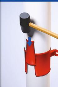
Первый хомут для водосточной трубы устанавливается на стене прямо под отводом. Хомуты устанавливаются максимально на двухметровом расстоянии, вертикально по отношению друг к другу, и крепятся шурупами к стене. Если хомут зафиксирован на стене, можно устанавливать водосточные трубы. Зажмите хомут вокруг трубы при помощи клина. Используйте резиновый молоток, чтобы загнать клин в нужное место.
