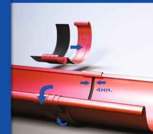
Для соединения желобов вставьте резиновый уплотнитель ребристой стороной вверх в соединитель желоба, зацепите заднюю кромку соединительной детали за желоб. Затем наложите внешний хомутик на выступ желоба и зажмите его специальной пластиной.
