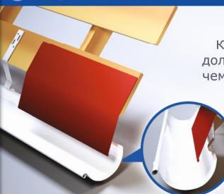
Карнизная планка или край кровли должны перекрывать желоб не более чем на 1/3 диаметра желоба.
